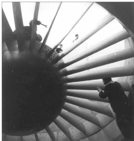
Szerelik a ventilátort, a járókerék átmérője 5460 mm
